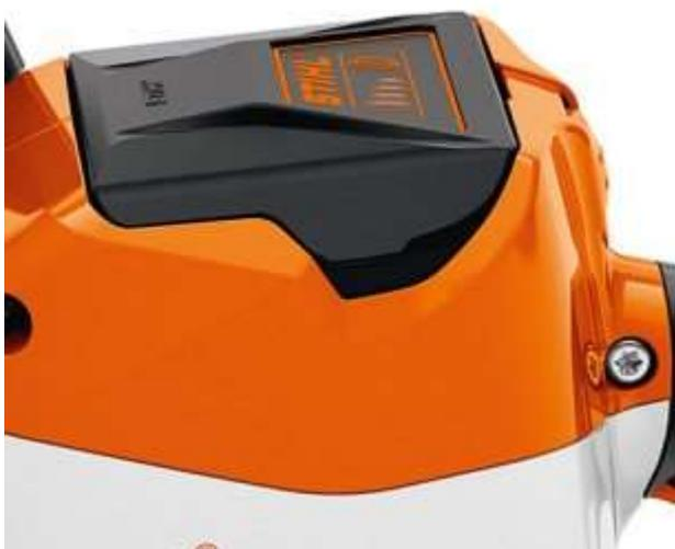
FÜR EINEN SICHEREN TRANSPORT. Sie können den Akku in zwei Stufen in das Gerät einschieben: In der ersten Raststufe ist der Akku fest im Gerät fixiert, berührt aber noch nicht die Kontakte und wird dadurch auch nicht entladen. In der zweiten Raststufe befindet sich der Akku in der Betriebsposition. (Abb. ähnlich)
