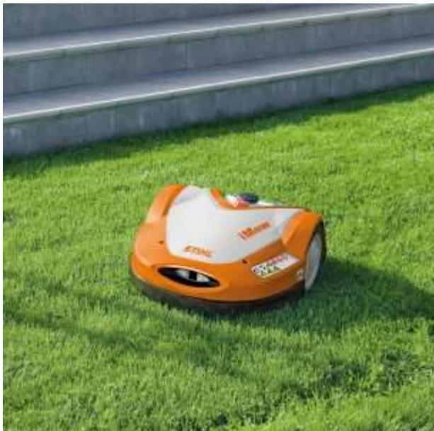
**SCHONT IHREN RASEN.** Werksmäßig erfolgt die Heimfahrt des iMOW® Mähroboters zur Dockingstation entlang des Begrenzungsdrahts. Der Mähroboter kann aber auch so eingestellt werden, dass er auf unterschiedlichen Spuren zur Dockingstation fährt. Dabei nutzt er ebenfalls den Verlegedraht, bewegt sich aber mit Hilfe eines wechselnden Versatzes zum Draht über den Rasen.
