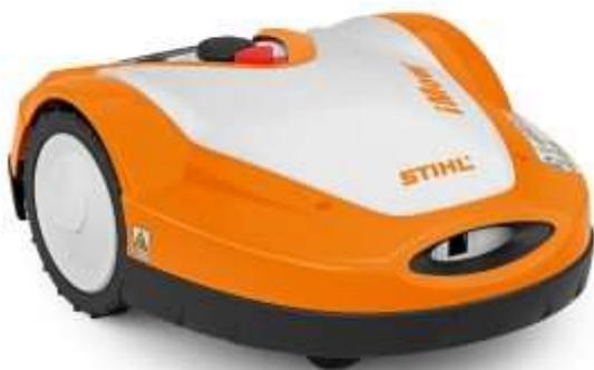
SCHÜTZT VOR HINDERNISSEN UND WITTERUNG. Stößt Ihr iMOW® Mähroboter während des automatischen Rasenmähens auf ein Hindernis, erkennen die in der beweglichen Haube integrierten Stoßsensoren das Objekt und veranlassen eine Richtungsänderung. Durch das robuste Material der Haube ist der iMOW® Mähroboter zudem gut vor Witterungseinflüssen geschützt.
