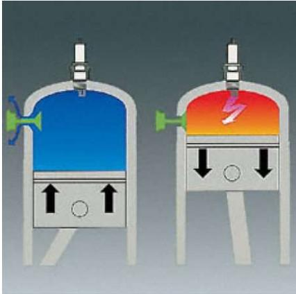
**KRAFTSPARENDES ANWERFEN.** Das Dekompressionsventil erleichtert das Anwerfen Ihres Gerätes. Beim Starten können Sie durch Öffnen des Ventils einen Teil des verdichteten Gemisches aus dem Zylinder entweichen lassen. Das schont das Anwerfsystem und Sie müssen weniger Kraft am Anwerfseil aufwenden.
