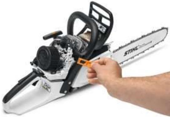
FÜR ZUVERLÄSSIGEN BETRIEB AUCH IN DER KALTEN JAHRESZEIT. Dank der Vergaservorwärmung können Sie auch im Winter zuverlässig mit Ihrer Motorsäge arbeiten. Mit nur einem einfachen Handgriff stellen Sie den Betrieb von Sommer auf Winter um. In der Winter-Einstellung umströmt vorgewärmte Ansaugluft den Vergaser, wodurch dieser nicht vereist.
