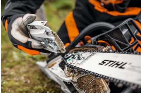
**SCHUTZ VOR VERLUST** Die Muttern sind verliersicher am Kettenraddeckel angebracht. Beim Abnehmen des Deckels ist es so nicht möglich, dass die Muttern herunterfallen und verloren gehen.
