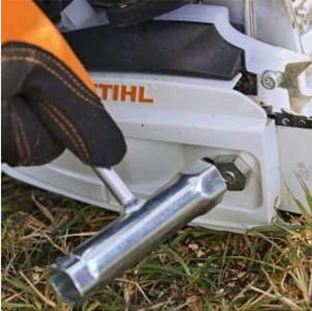
Die Spannschraube wird seitlich durch den Kettenraddeckel hindurch betätigt. Das verhindert den Kontakt der Hand mit der scharfen Sägekette und den Spitzen des Krallenanschlages.
