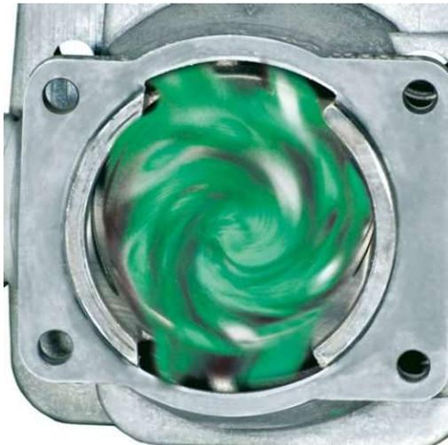
**FÜR WENIGER KRAFTSTOFFVERBRAUCH UND EINE HOHE LEISTUNG.** Dank der STIHL Vier-Kanal-Technik arbeiten Sie mit Ihrem Gerät besonders kraftstoffarm und leistungsstark. Die vier Überströmkanäle führen das Kraftstoff-Luft-Gemisch gezielt und komprimierter in den Zylinder, was den Kraftstoff optimal verbrennt und die Leistung des Motors deutlich erhöht.
