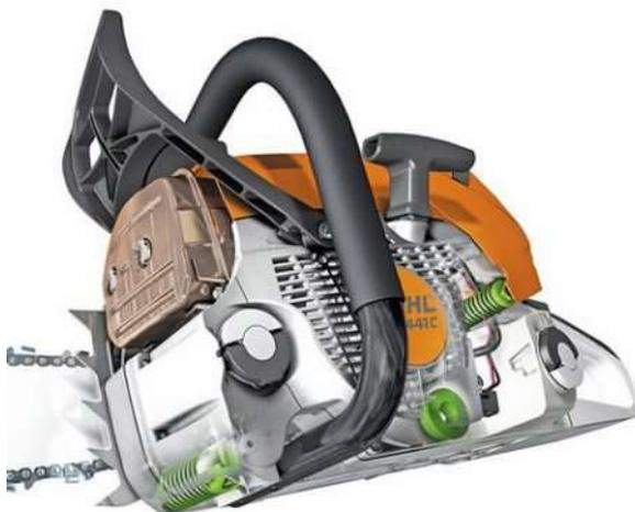
**FÜR EIN ANGENEHMERES ARBEITEN.** Bei der Kraftentfaltung Ihres Geräts entstehen Vibrationen, die sich vor allem im Griffbereich bemerkbar machen. Die Puffer- und Federelemente des STIHL Antivibrationssystems reduzieren die Übertragung der Motorschwingungen auf den Griffbereich und damit auf Ihren Körper. Der Effekt: Ihr Gerät liegt ruhiger in der Hand und Sie können wesentlich ermüdungsärmer arbeiten.
