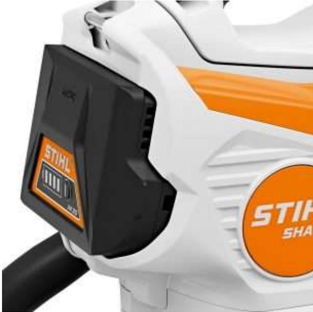
Der Akku kann in 2 Stufen in das Gerät eingeschoben werden. In der Zwischenposition ist der Akku fest im Akkuschaft eingerastet und so vor Herausfallen geschützt. Um die Betriebsbereitschaft herzustellen, muss der Akku komplett in den Schacht geschoben werden. Der Akku ist somit kontaktiert.
