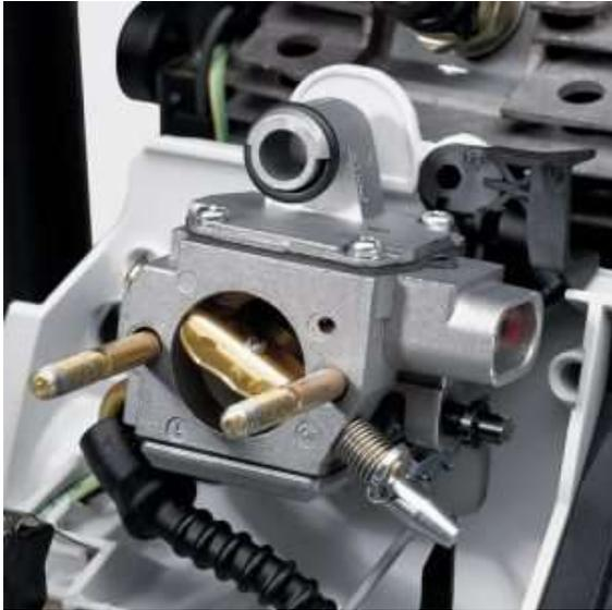
GERINGERER WARTUNGSAUFWAND. Ein Regelsystem im Vergaser, der Kompensator, sorgt durch Druckausgleich dafür, dass trotz zunehmender Verschmutzung des Luftfilters Motorleistung, Abgasqualität und Kraftstoffverbrauch über einen langen Zeitraum nahezu konstant bleiben. Reinigen Sie daher den Luftfilter erst dann, wenn ein spürbarer Leistungsabfall eintritt. So können Sie lange Zeit wartungsfrei arbeiten.
