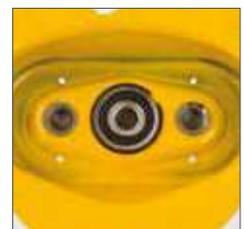
Kugellager im Getriebedeckel
